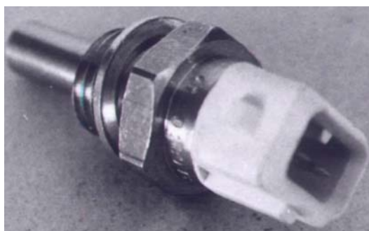
Рис. 4-6. Датчик температуры жидкости в системе охлаждения.
