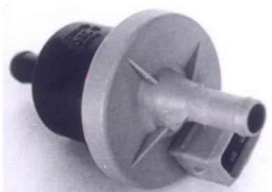
Рис. 4-14. Продувочный клапан угольного фильтра.
