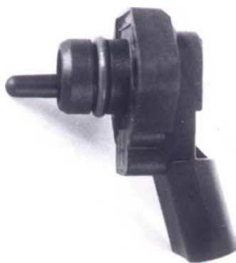
Рис. 4-5. Датчик температуры и давления впускного коллектора.
