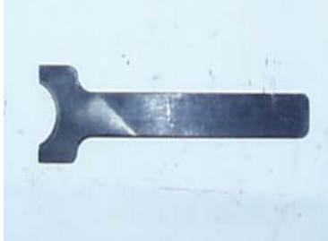
Приспособление для установки кольца Е-зажима
